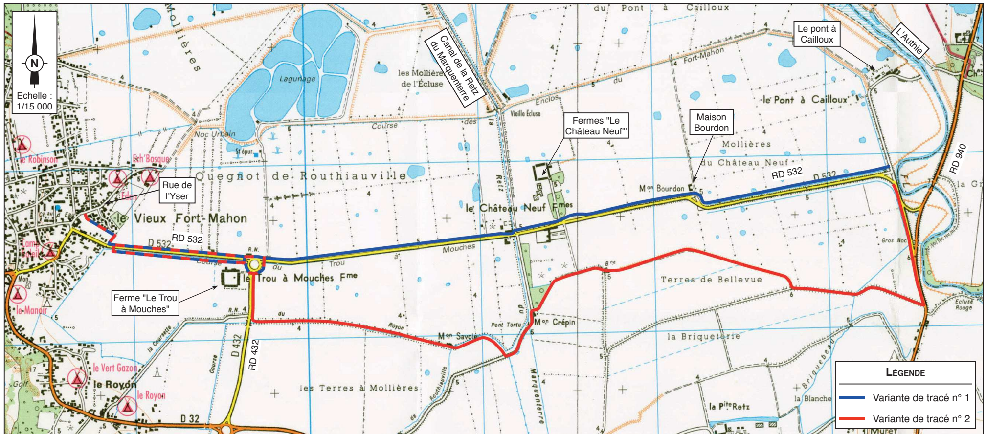
FIGURE 182 : TRONÇON 7 - VARIANTES DE TRACÉ 1 ET 2
